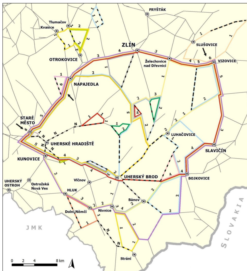
Obr. 19: Ukázka skutečných dopadů události z července 1997 v části Zlínského kraje. Na zjednodušené síti jsou čárkovaně označeny úseky, které byly přerušeny. Barevně jsou potom jejich objízdné trasy. Čísla ukazují na počet objízdných tras vedoucích přes daný úsek. Čárkovaný úsek bez barvy nemá objízdnou trasu. Šipky ukazují na úseky, které byly využívány jako součást objíždky jiného úseku šestkrát.
