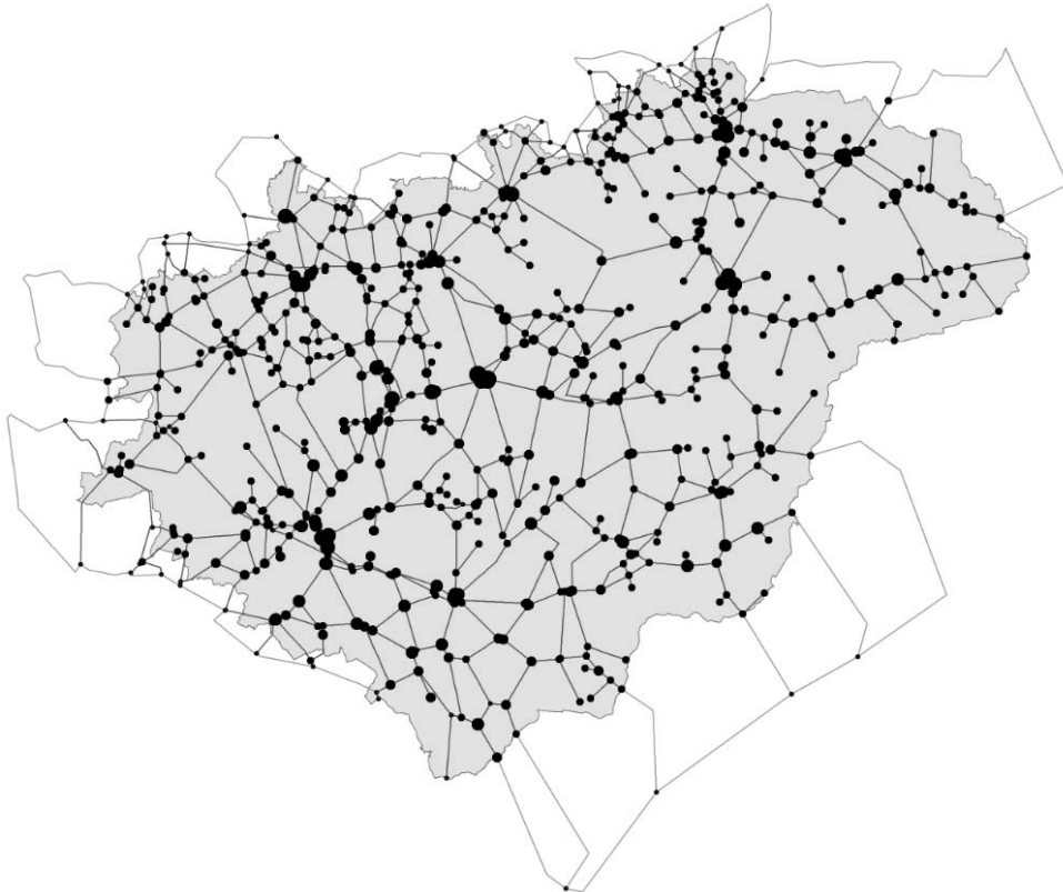
Obr. 20: Silniční síť Zlínského kraje ve zjednodušené podobě. Průměr jednotlivých uzlů odpovídá počtu obyvatel. Z prvního pohledu je zřejmé, kde se nacházejí centra osídlení a kolik do nich směřuje úseků komunikací. Objízdné trasy vedené za hranice kraje a ČR je třeba pro účely modelování udržovat průjezdné, abychom dosáhli všech vnitřních rozpadů sítě. Zdroj dat: Silniční databanka Ostrava.
